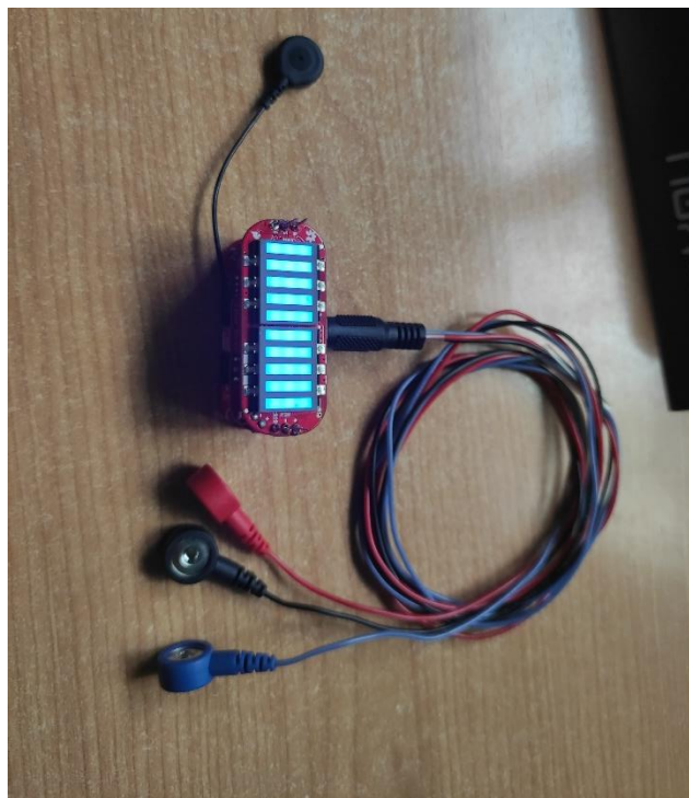
Figura 7 Segona iteració afegint un mòdul addicional de cablejat via jack amb cablejat extern. Disseny descartat a posteriors iteracions.
