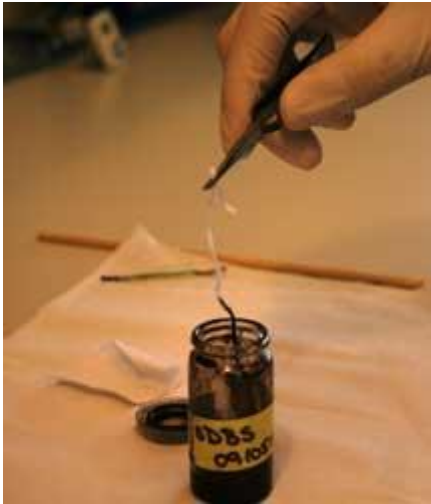
Figura 5: Paper tenyit amb nanotubs de carboni.
