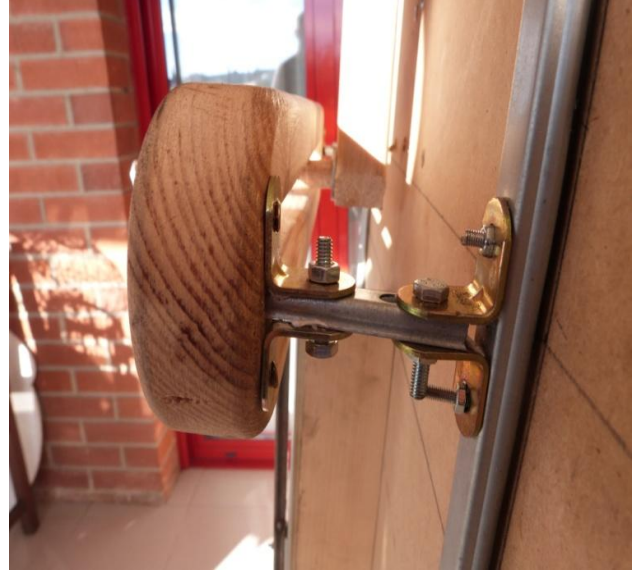
Figura 38. Unió de la peça el·líptica amb les guies laterals. (Font pròpia)
