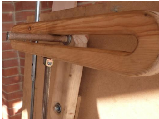
Figura 51. L'eix no toca a tot dos costats. (Font pròpia)
