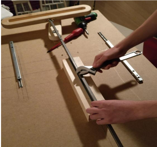
Figura 37. Acoblant el pistó a la guia central. (Font pròpia)
