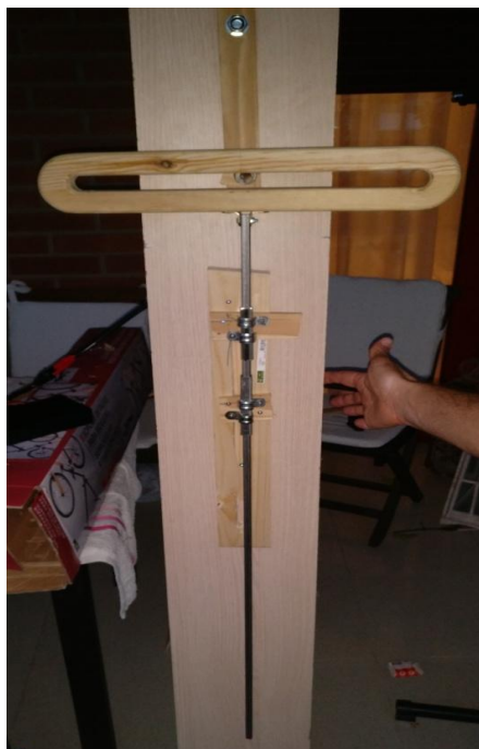
Figura 32. Pistó acoblat a la peça el·líptica. (Font pròpia)
