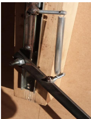
Figures 49 i 50. Molla acoblada entre el pistó i la vareta. (Font pròpia)
