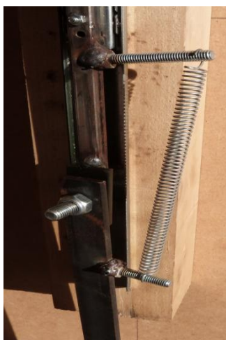
Figures 49 i 50. Molla acoblada entre el pistó i la vareta. (Font pròpia)
