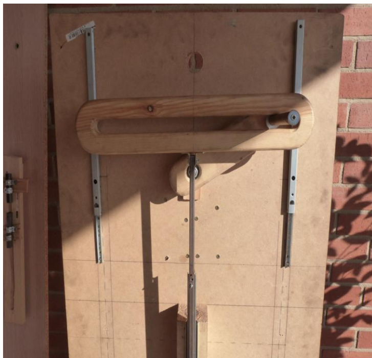
Figura 40. Part de l'enginy corresponent al jou escocès . (Font pròpia)
