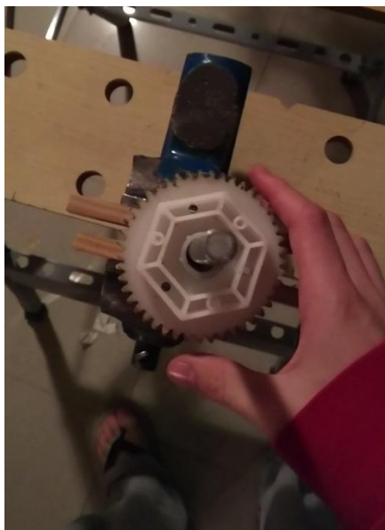
Figura 24. Eix del motor i roda dentada pertanyent a la reducció. (Font pròpia)
