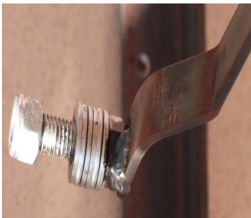
Figures 48 i 49. Unió entre el pistó i el pedal. (Font pròpia)
