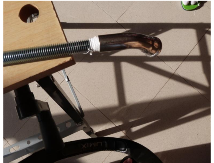
Figures 25, 26 i 27. Explicació visual del procés d'adaptació del tub a l'eix amb tefló. (Fonts pròpies)
