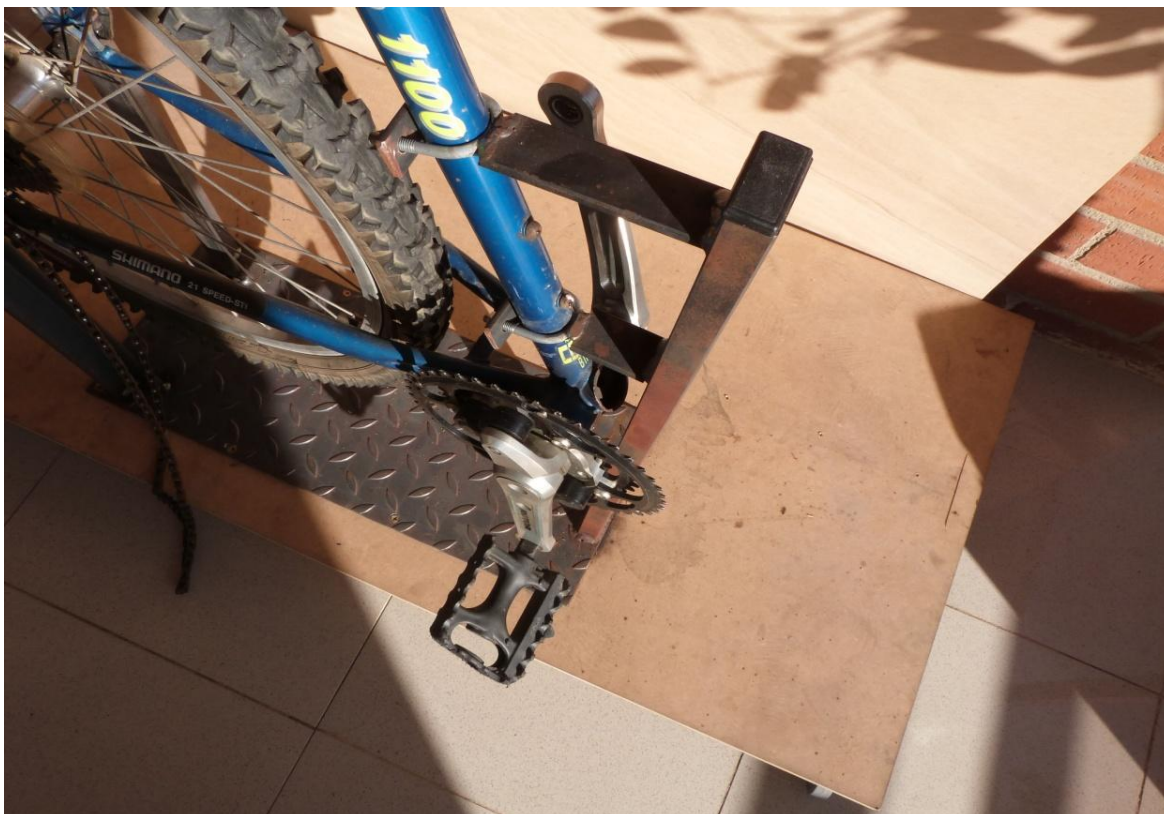
Figures 44 i 45. Subjeccions per al sistema de plat i pinyó. (Font pròpia)
