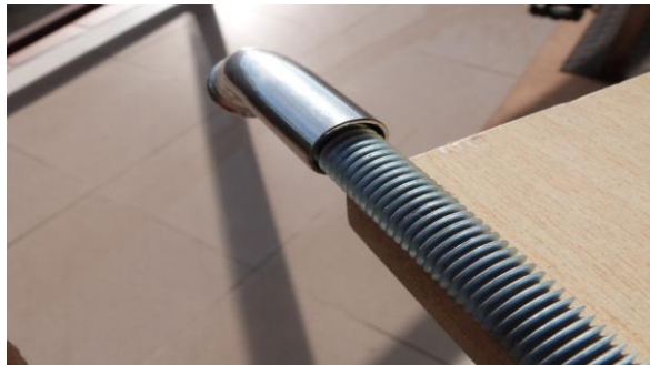
Figures 25, 26 i 27. Explicació visual del procés d'adaptació del tub a l'eix amb tefló. (Fonts pròpies)
